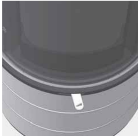
Abb. 4.6 Verbrennungslufthebel ganz rechts, Verbrennungsluft komplett geöffnet, Anheizen
