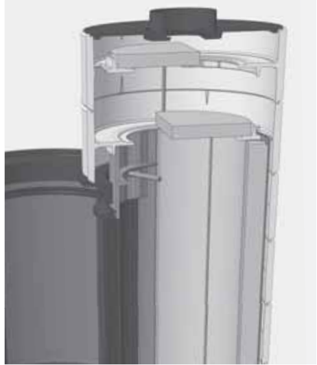
Abb. 4.36 Entnehmen der Umlenkungen (Heizgasführung)
