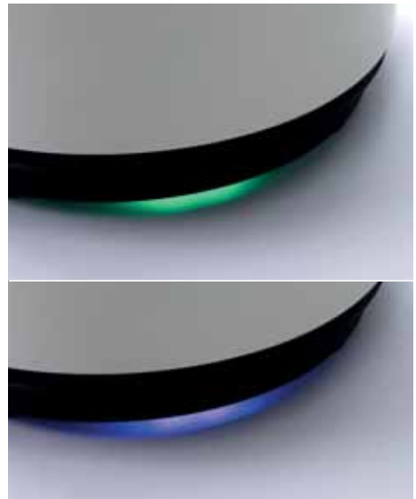
Abb. 4.23 LED-Lichtsignal zunächst „GRÜN“ dann „BLAU“
