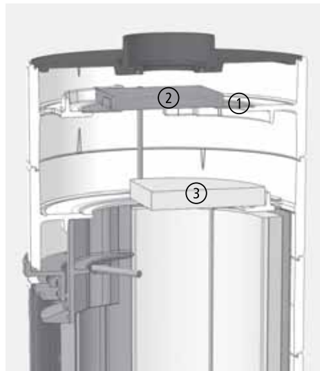
Abb. 3.20 Lage der Katalysator-Elemente beim PEPPA tec, Schnittdarstellung
