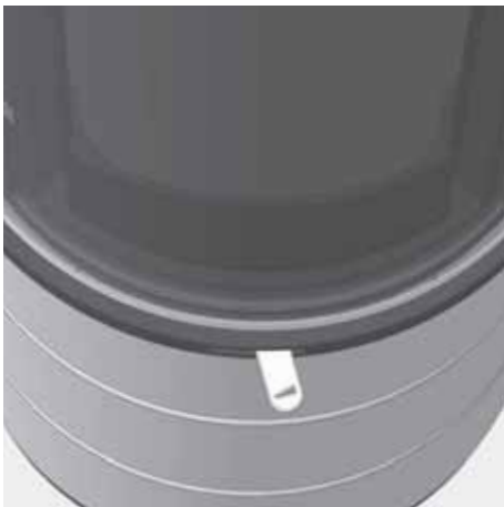
Abb. 4.4 Verbrennungslufthebel ganz rechts, Verbrennungsluft komplett geöffnet, Anheizen
