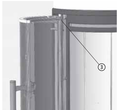
Abb. 3.7 Madenschraube, Stiftsicherung lösen
