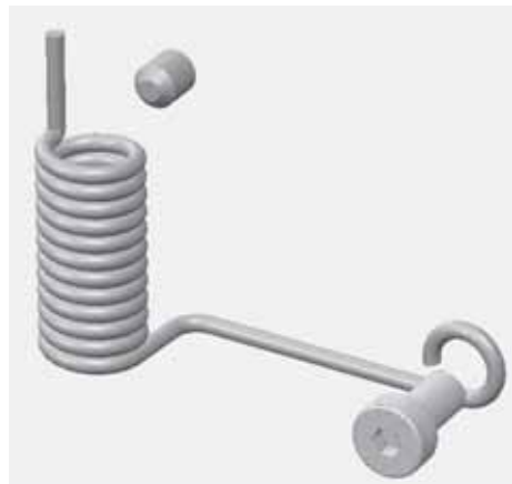
Abb. 3.10 Türfeder, Madenschraube und Spanschraube
