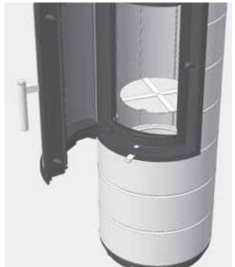
Abb. 4.34 Entnehmen des Bodenblechs im Brennraum
