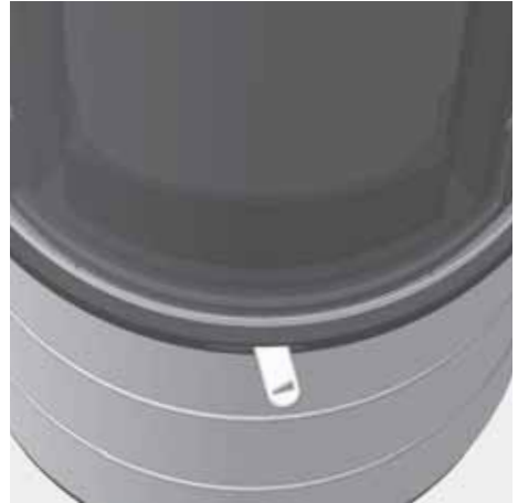
Abb. 4.11 Verbrennungslufthebel ganz rechts, Verbrennungsluft komplett geöffnet, Anheizen
