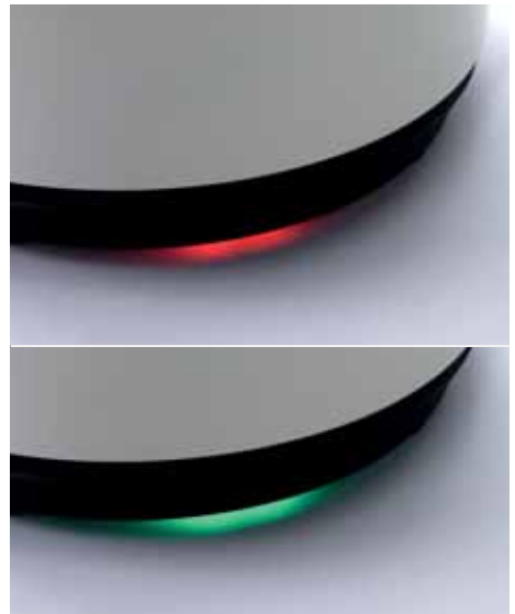
Abb. 4.28 LED-Lichtsignal bei Betrieb „ROT“ dann wieder „GRÜN“
