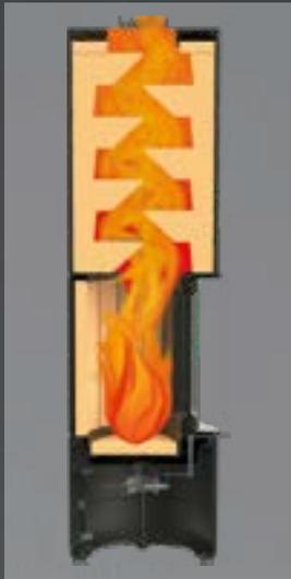
Lenkung der Heizgase durch Schamottekern: effiziente Langzeit-Wärmespeicherung
