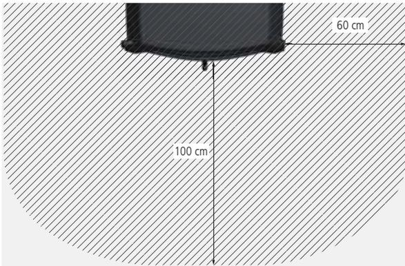
Abb. 1.3 Mindestabstände im Bereich der Sichtfenstertür
