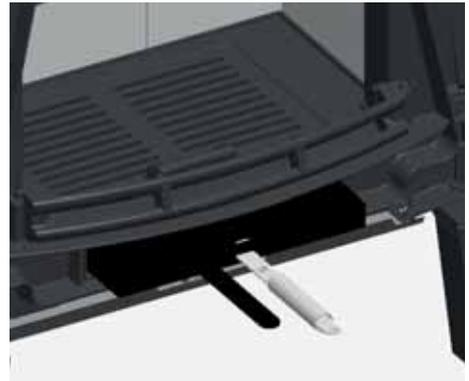
Abb. 4.8 Aschekasten mit Bediengriff herausziehen
