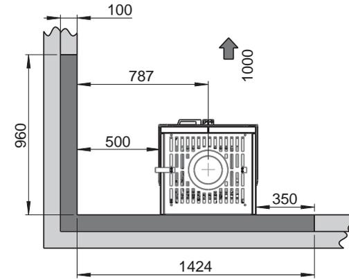
Minimale Abmessungen der Fußbodenplatte X,Y =
