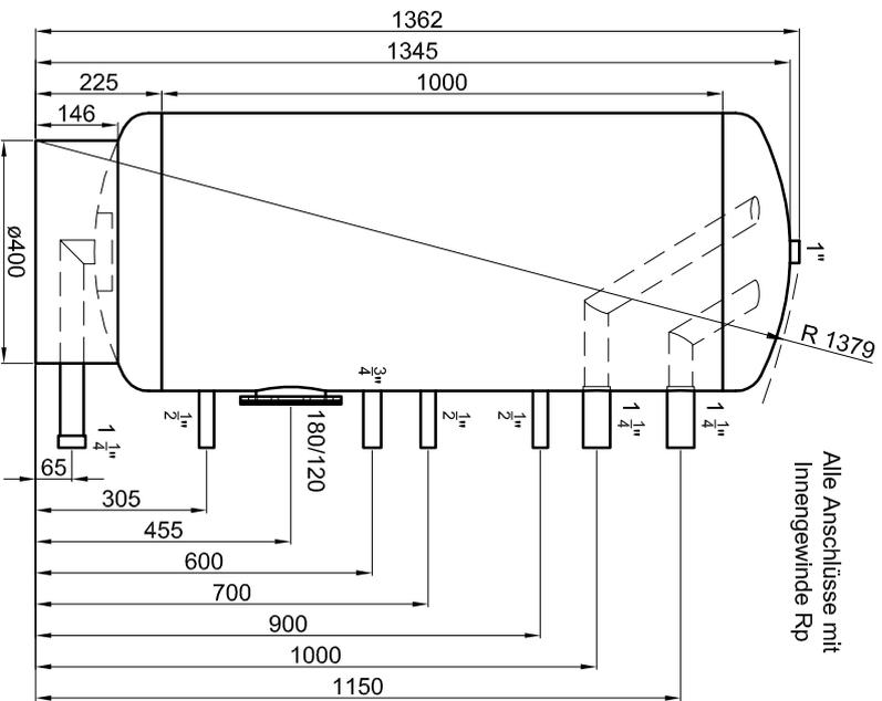
Alle Anschlüsse mit Innengewinde Rp
