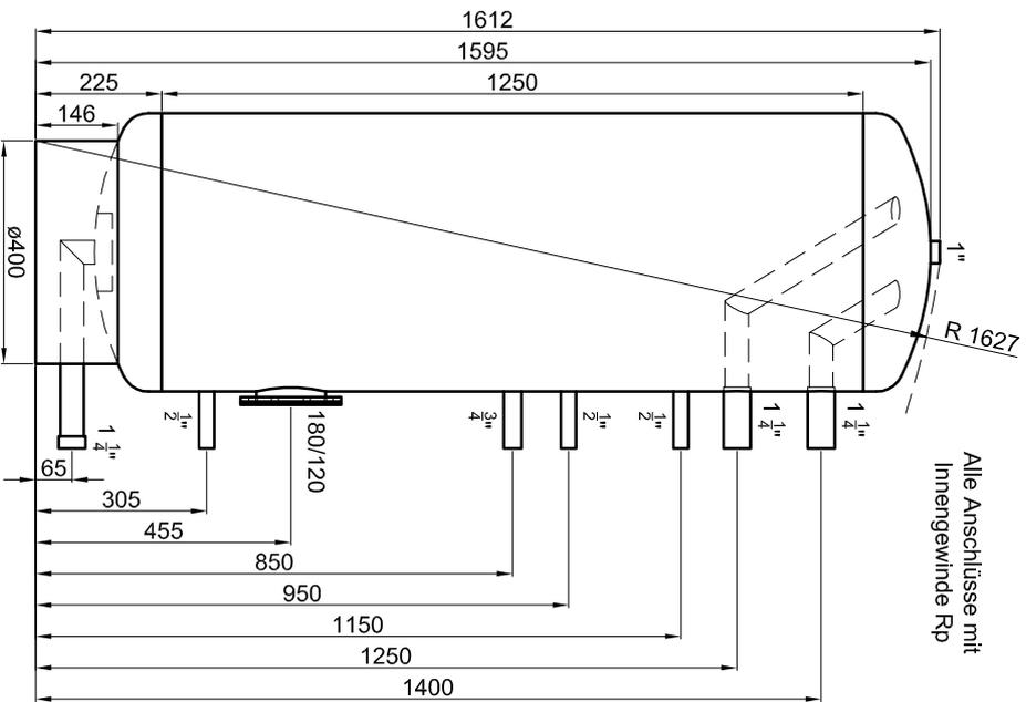
Alle Anschlüsse mit Innengewinde Rp
