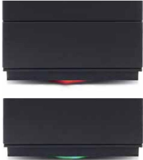
Abb. 4.26 LED-Lichtsignal bei Betrieb „ROT“ dann wieder „GRÜN“
