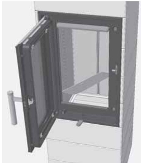
Abb. 4.29 Entnehmen des Bodenblechs im Brennraum
