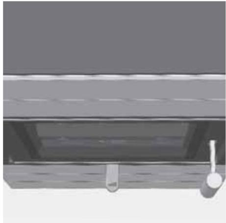
Abb. 4.5 Verbrennungslufthebel mittig, Verbrennungsluft auf Nennwärmeleistung
