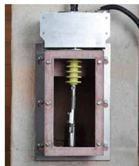
3. Elektrode einfügen und Isolator-kammer am Rahmen befestigen
