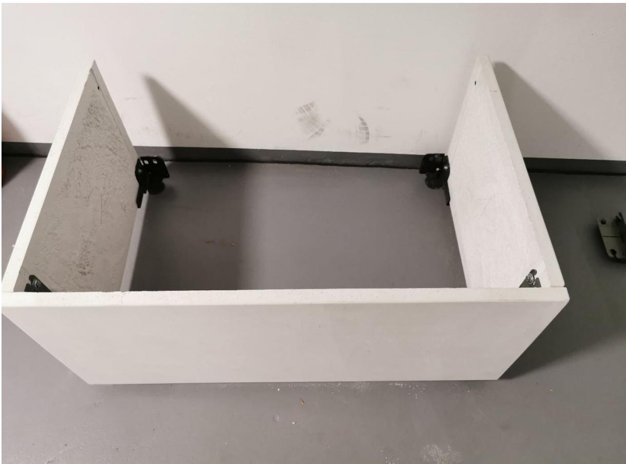
Prüfen Sie, ob die Füße komplett an die Wand gestellt werden können. Falls das nicht möglich ist, können Sie mit einem Winkelschleifer mit Metalltrennscheibe diese leicht zuschneiden.
