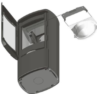
3. Heben Sie die Rückplatte an und nehmen Sie sie heraus
