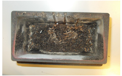
BEISPIEL VERSCHMUTZTE BRENNSCHALE
