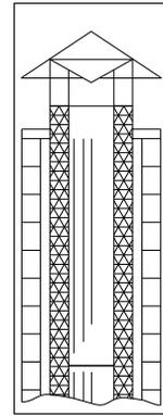
Schornstein für Stahl-Schornstein mit einem internen Umlenkkegel für die Rauchgase.
