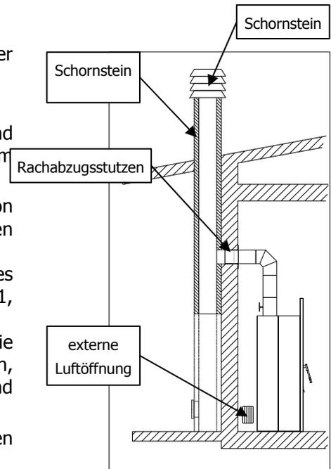
Darstellung eines typischen, korrekt angeschlossenen Schornsteins. Am Fuße des externen, ansteigenden Rohrs befindet sich eine mit Tür ausgestattete, luftdichte Kammer, in welcher die festen Verbrennungsprodukte gesammelt und entladen werden.
