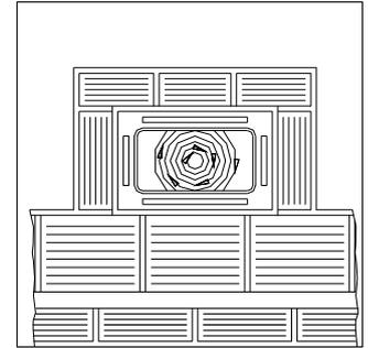
Schornstein aus Stahl AISI 316 mit Doppelkammer, die mit Keramikfaser oder gleichwertigem Material gedämmt ist. Das Dämmungsmaterial kann einer Temperatur von 400 °C standhalten.
