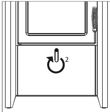
**Abb. 12** Zufuhr sekundärer Luft
