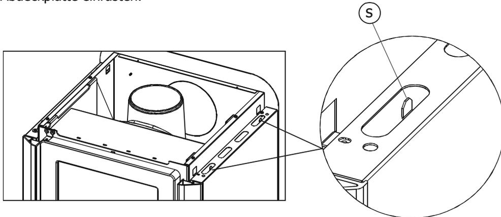
Abbildung 11 - Position der metallenen Abdeckplatte (Kaminofen Kasai)
