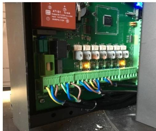
Billede 2: Styringsprint på Aduro Hybrid
