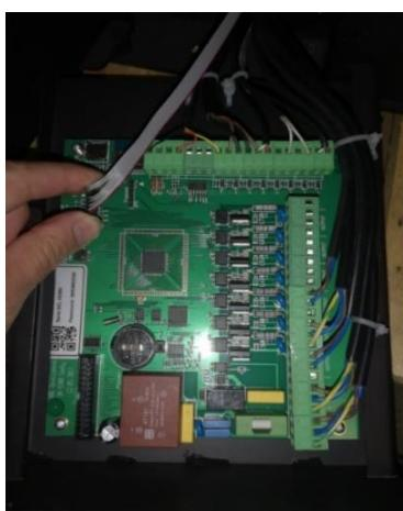
Bild 1: Trennen Sie das Displaykabel
