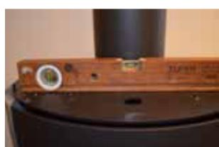
**9:** Überprüfen Sie, dass die Stahlplattform so weit unten wie möglich und in der Waage liegt.
