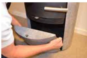
**24:** Montez précautionneusement la pierre avec le joint vers le bas dans le rack à bois et enfoncez l'ergot situé en haut de façon à ce qu'il puisse rentrer dans le trou prévu à cet effet dans les rainures du châssis - mettez le tout bien en place.
