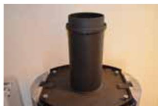
**5:** Wenn der Abgang oben etabliert werden soll, muss der Gusseisenstutzen oben am Ofen abmontiert und das mitgelieferte Rohr montiert werden. Denken Sie an die Dichtung zwischen Rohr und Ofen. Der Gusseisenstutzen wird anschließend oben auf das mitgelieferte Kaminrohr montiert. Denken Sie an die Dichtung zwischen Rohr und Stutzen.
