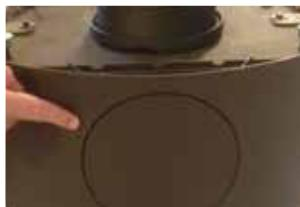
**6:** Si vous souhaitez une évacuation par l'arrière, démontez le conduit d'entrée du sommet du poêle. Sortez délicatement les plaques pré découpées sur la plaque extérieure et l'écran thermique du poêle. Démontez la plaque supérieure montée sur le poêle (sortez-la par le foyer) et montez-la au-dessus du poêle à la place du conduit d'entrée. Montez le conduit d'entrée à l'arrière du poêle. N'oubliez pas les joints.
