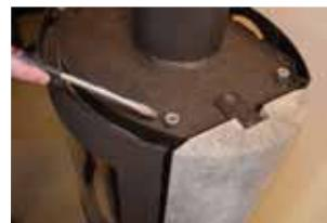
**3:** Montieren Sie die 4 oder 5 Schrauben ab, die oben am Rohofen montiert sind. Diese dürfen nicht weggeworfen werden - sie werden unter Punkt 21 wieder verwendet.
