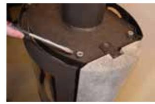
**3:** Retirez les 4 ou 5 vis montées sur le dessus du corps du poêle. Ne les jetez pas, elles doivent resservir au point 21.
