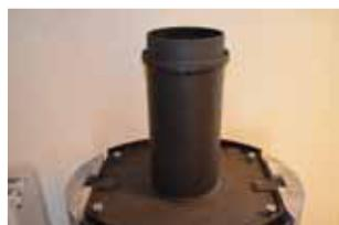
**5:** Als u een afvoer aan de bovenzijde wilt, verwijder dan het gietijzeren pijpstuk bovenop de kachel en installeer de meegeleverde pijp. Denk aan de pakking tussen de pijp en de kachel. Het gietijzeren pijpstuk installeert u bovenop de meegeleverde rookpijp. Denk aan de pakking tussen de pijp en het pijpstuk.
