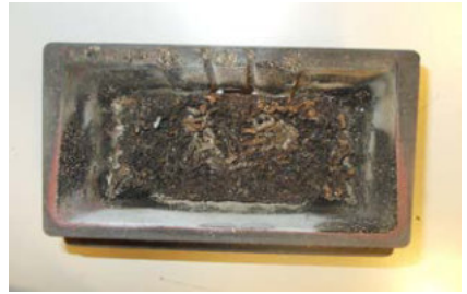
BEISPIEL VERSCHMUTZTE BRENNSCHALE
