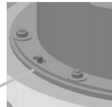
Bei der Montage der Rauchfangeinheit Verdrehschutz
