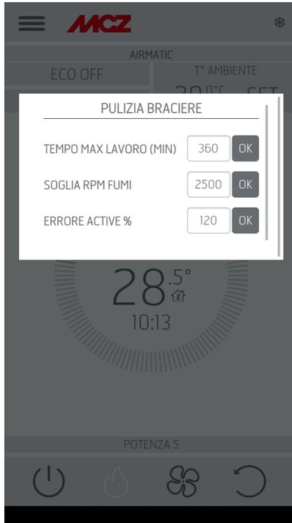
Auf dieser Seite kann der maximale Zeitintervall eingestellt werden, nach dem das Gerät einen automatischen Reinigungszyklus der Brennschale durchführen muss bzw. die Asche entsorgt werden muss, um eine Verstopfung zu verhindern.
