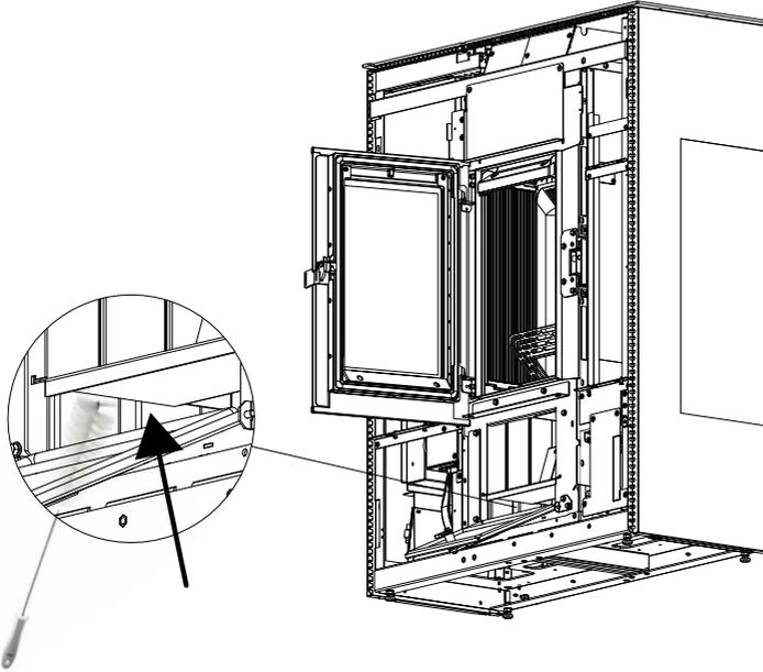
Dann das obere Teil aus Calorite „J“ herausnehmen, dazu die Brennrammertür öffnen und oben die Calorite-Platte „J“ nach oben anheben und nach rechts oder links neigen, um sie aus den Halterungen zu lösen, und herauszunehmen.
