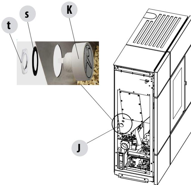
Der Pellet-Sensor ist eine Anzeige für die Brennstoffreserve, der dazu dient, dem Benutzer zu melden, dass die Pellets fast verbraucht sind.
