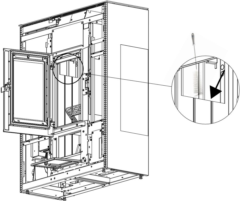
Die herabgefallene Asche aus dem unteren Fach reinigen und alle Teile des Ofens in umgekehrter Reihenfolge wieder montieren.
