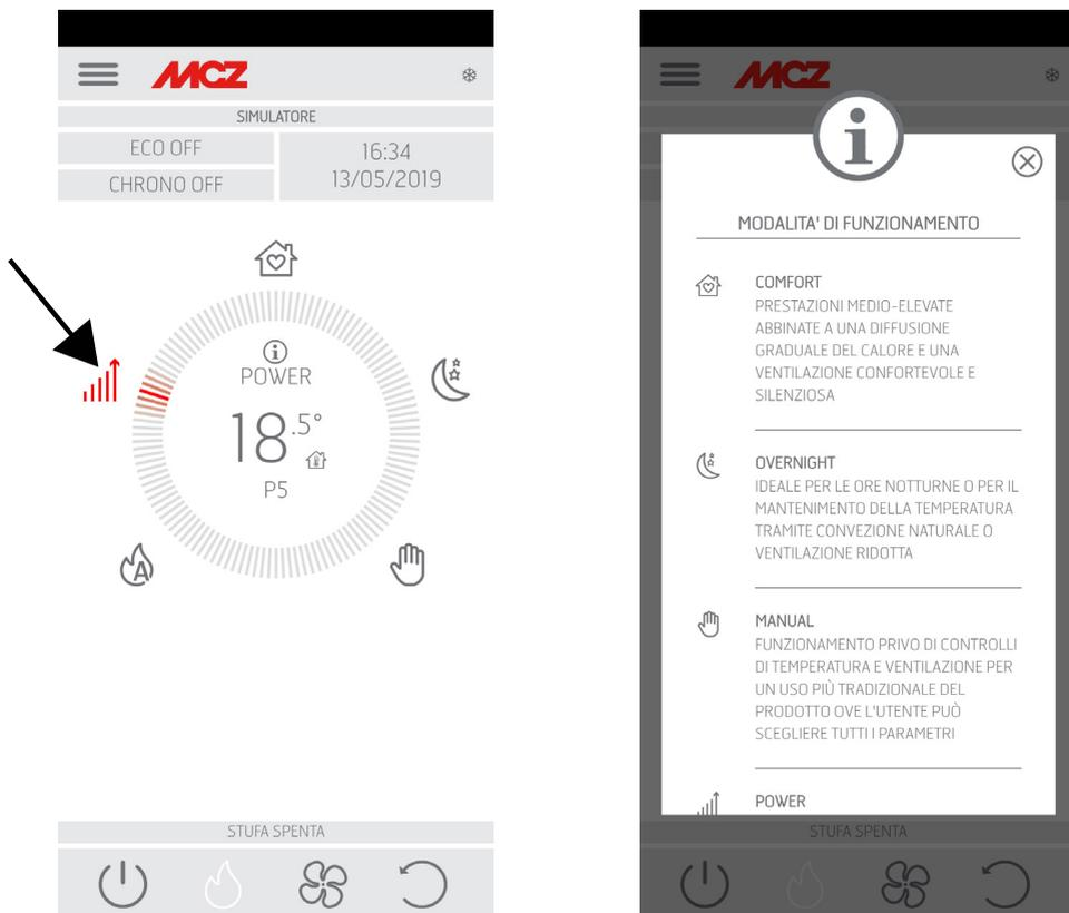
Um die gewünschten Parameter einzustellen, in die Mitte des Rings in Übereinstimmung der angegebenen Temperatur drücken und es wird ein Popup geöffnet, um die Einstellung vorzunehmen.
