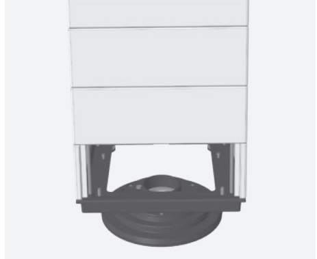
Abb. 3.10 Aufsetzen des Kaminofens auf der Drehkonsole
