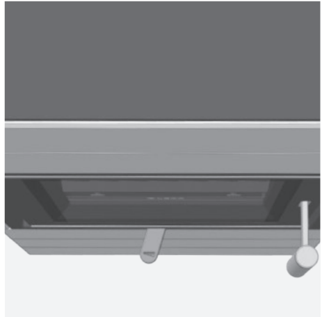
Abb. 4.7 Verbrennungslufthebel ganz links, Verbrennungsluft geschlossen
