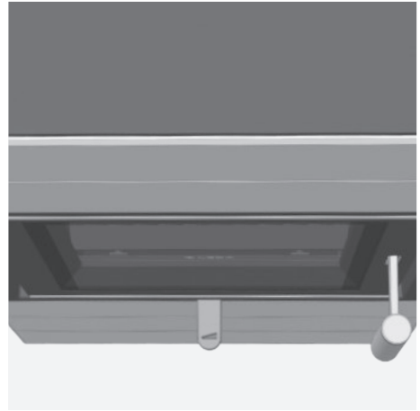
Abb. 4.5 Verbrennungslufthebel mittig, Verbrennungsluft auf Nennwärmeleistung
