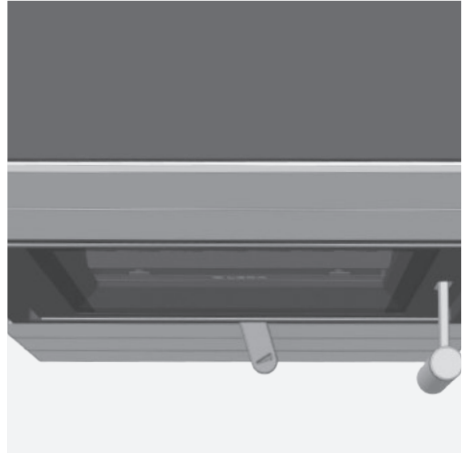
Abb. 4.6 Verbrennungslufthebel ganz rechts, Verbrennungsluft komplett geöffnet, Anheizen
