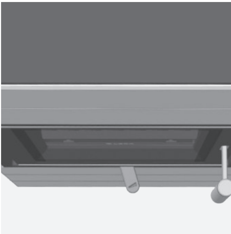
Abb. 4.4 Verbrennungslufthebel ganz rechts, Verbrennungsluft komplett geöffnet, Anheizen
