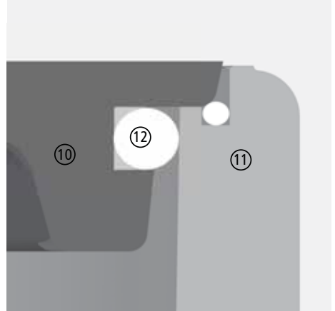
Abb. 3.28 Dichtnut im obersten Gussring, Dichtprofil der Abdeckung
