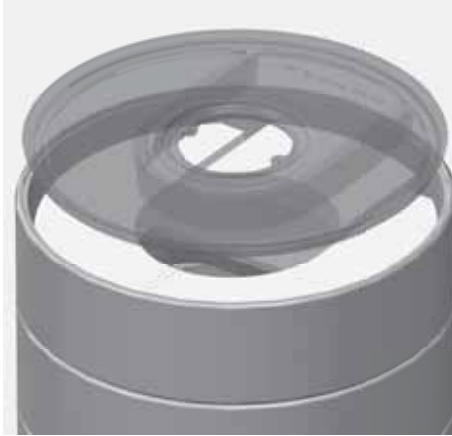
Abb. 3.27 Einlegen der Guss-Abdeckung
