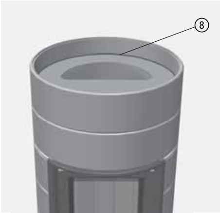
Abb. 3.24 umlaufende Kittfuge über zweiten Speichereinlage
