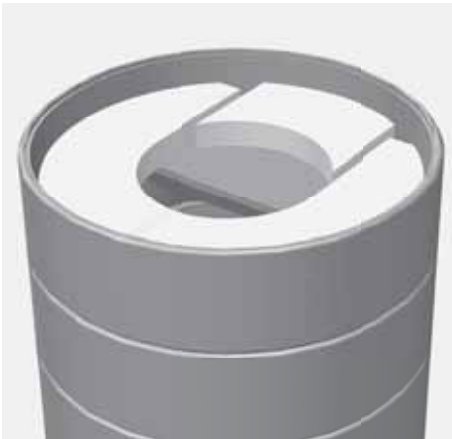
Abb. 3.26 Vermiculit-Einleger bei oberem Abgasanschluss
