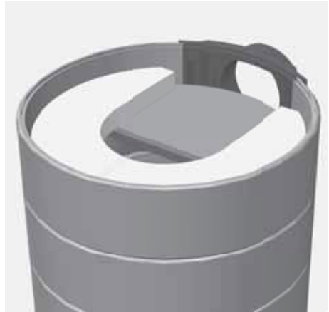
Abb. 3.25 Vermiculit-Einleger bei seitlichem Abgasanschluss
